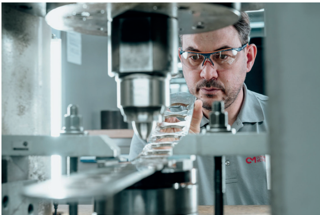
Découpe de carrures en platine
