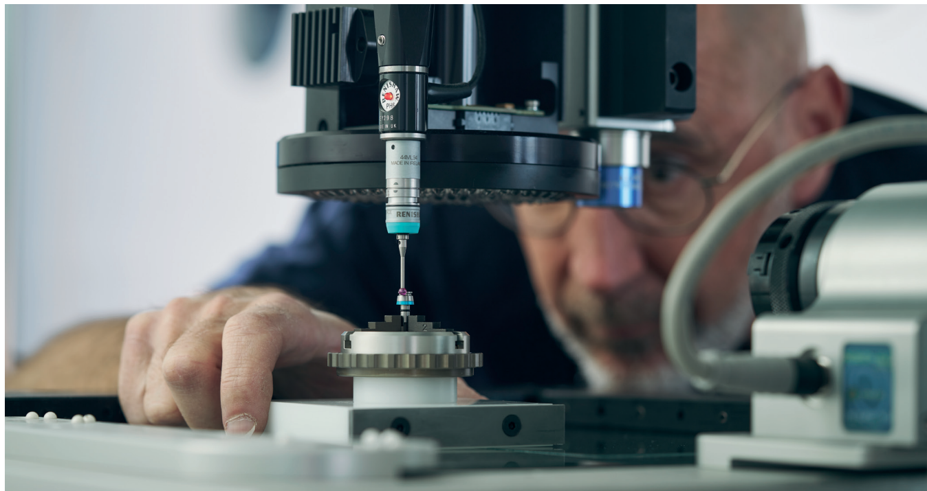
Mesure d'une pièce par palp sur une Machine MicroVu VERTEX 312
