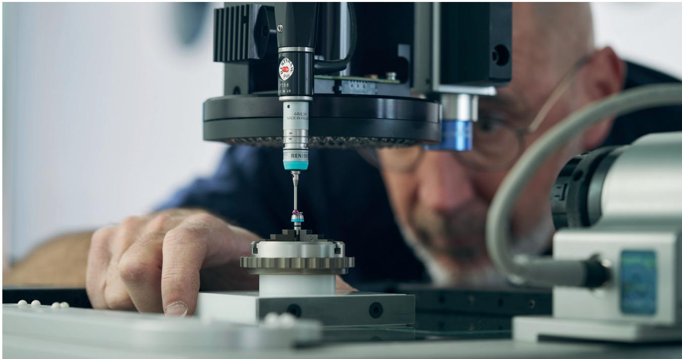
Messung eines Werkstücks durch Abtasten auf einer MicroVu VERTEX 312 Maschine
