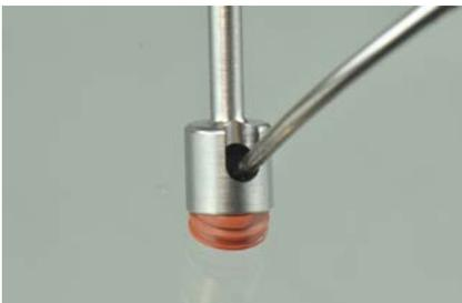
Poi inserire uno strumento nel foro laterale dell'estrattore CM LOC® e far fuoriuscire il CM LOC® Housing. Per facilitare l'estrazione si consiglia di riscaldare brevemente su fiamma l'estrattore CM LOC®.
