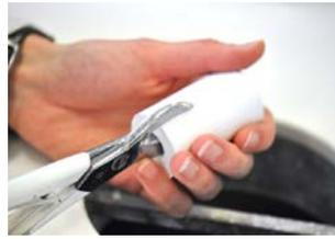
Die Feinausbettung erfolgt mit abrasivem,  $110\mu\text{m}$  Korundstrahlmittel und einem Druck von 2 Bar.
