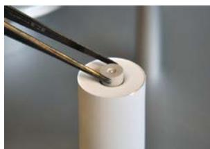
Inserire il punzone di pressatura nel cilindro con la tenuta in gomma rivolta verso il basso.
