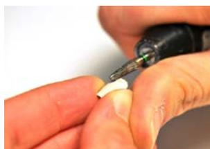
Prima della sabbiatura irruvidire la superficie con una fresa diamantata.
