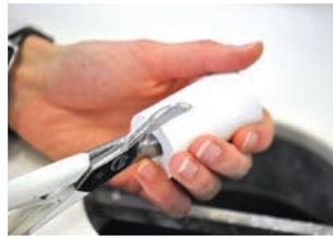
Die Feinausbettung erfolgt mit abrasivem, 110 $\mu$ m Korundstrahlmittel und einem Druck von 2 Bar.
