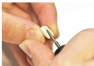
Nach der Überarbeitung mit den Fräsen wird das Gerüst mit abrasivem 110µm Strahlmittel mit 2 Bar Druck abgestrahlt, anschließend mit ölfreier Druckluft gut reinigen.
