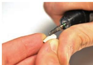
Vor dem Strahlen wird die Oberfläche mittels einer Diamantfräse aufgeraut.
