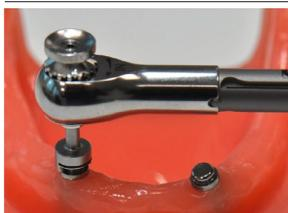
A continuación, fíjelo con una llave de carraca dinamométrica aplicando el par correspondiente. Procure que la herramienta de atornillado CM LOC® se apoye bien sobre el pilar. Asegure todos los componentes para evitar que sean aspirados. Después del montaje, la herramienta de atornillado CM LOC® puede retirarse lateralmente girándola ligeramente en sentido contrario.
