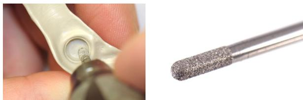
Pekkton® ivory Oberfläche mittels Diamant aufrauen. Tiefe Drehzahl und wenig Druck. Empfohlen wird eine Drehzahl zwischen 5'000 – 10'000 Umdrehungen pro Minute. Reinigung mit Alkohol.
