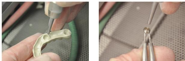
Abstrahlen des Pekkton® ivory Gerüsts und mit nicht rezyklierten Aluminiumoxid ( $\text{Al}_2\text{O}_3$ ) mit einer Körnung von 110  $\mu\text{m}$  und einem Druck von 2 bar. Anschliessend mit ölfreier Druckluft oder mit Alkohol reinigen. Nicht mit dem Dampfreiniger!
