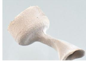
Das Grobausbetten erfolgt mit einer Ausbettzange und mit Vorsicht. Das Ausbetten erfolgt sobald die Muffel handwarm ist. Beim grossen Arbeiten nicht mit der Ausbettzange ausbetten. Die Feinausbettung erfolgt mit abrasivem, 110 µm Korundstrahlmittel und einem Druck von 2 bar. Einmal verpresstes Material darf nicht wiederverwendet werden.
