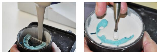
Die Einbettmasse wird in einem dünnen Strahl vorsichtig in den Muffelformer eingefüllt, bis der Rand der Wachsobjekte erreicht ist. Mit einem angefeuchteten Pinsel (damit der Masse keine Feuchtigkeit entzogen wird) die Kavität feineinbetten. Es kann dazu auch eine dünne Sonde verwendet werden, wobei darauf geachtet werden muss, dass die meist sehr feinen Wachsänder nicht beschädigt werden.
