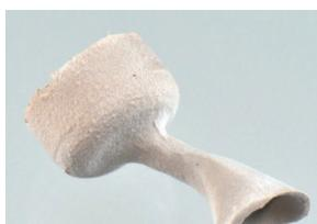
El desenmuflado hasta se realiza con tenazas teniendo precaución. El desenmuflado se realiza en cuanto la mufla está tibia. En las piezas más grandes, no desenmuflar con tenazas. El desenmuflado fino se lleva a cabo con un abrasivo de corindón de 110 µm y una presión de 2 bar. El material prensado una vez no debe reutilizarse.
