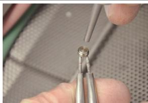
Chorrear la estructura de Pekkton® ivory con óxido de aluminio no reciclado (Al<sub>2</sub>O<sub>3</sub>) con un tamaño de grano de 110 µm y una presión de 2 bar. A continuación, limpiar con aire a presión libre de aceite o con alcohol. ¡No utilizar un limpiador de vapor!
