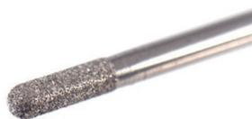
Conferir rugosidad a la superficie con una fresa de diamante. Emplear una velocidad de giro reducida y una presión reducida. Se recomienda una velocidad de giro de entre 5000 y 10.000 rpm.
