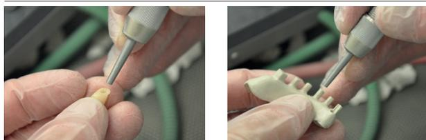
Chorrear los dientes artificiales con óxido de aluminio no reciclado (Al<sub>2</sub>O<sub>3</sub>) con un tamaño de grano de 110 µm y una presión de 2 – 3 bar. Chorrear las estructuras de Pekkton® ivory con óxido de aluminio no reciclado (Al<sub>2</sub>O<sub>3</sub>) con un tamaño de grano de 110 µm y una presión de 2 bar. A continuación, limpiar con aire a presión libre de aceite o con alcohol. ¡No utilizar un limpiador de vapor!
