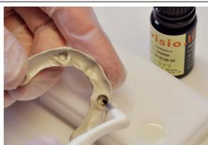
Bloquear las posibles partes solapadas con cera. Aislar el modelo. Aplicar primer para composite sobre la superficie de la estructura de Pekkton® ivory y fotopolimerizar según las instrucciones de uso del fabricante.
