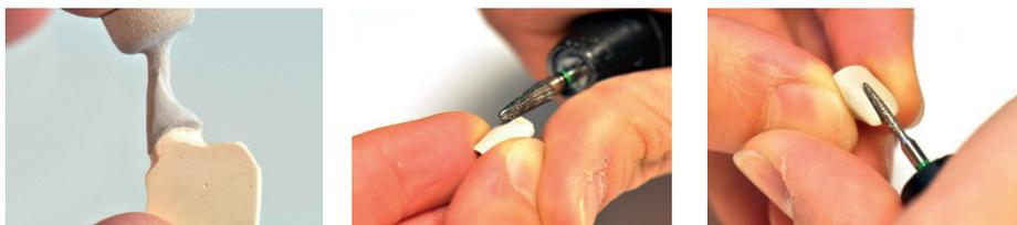
Mediante fresas de dentado cruzado se le confiere la forma definitiva a la estructura. El repasado se realiza a 5000 - 10.000 rpm como máximo. No trabajar con una presión demasiado elevada sobre el objeto. Antes del chorrear, se crea rugosidad en la superficie con ayuda de una fresa de diamante. Limpiar con alcohol.
