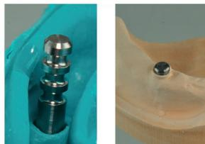
Envoyer ensuite l'empreinte au laboratoire dentaire pour la fabrication du modèle pour le rebasage selon la technique conventionnelle suivie de la finition et du polissage de la prothèse. Éliminer la résine excédentaire autour du boîtier de parties femelles CM LOC® avec une fraise ronde. Remplacer ensuite l'insert de processus dans le boîtier de parties femelles CM LOC® par une pièce rétentive Pekkton® au niveau de force souhaité.
