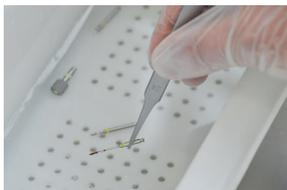
Sumerja los productos (desmontados) durante 5 min en agua fría (<math><40\text{ }^{\circ}\text{C}</math>/104 °F). Cepille el exterior y el interior con agua fresca utilizando un cepillo de nailon suave y elimine todas las impurezas (utilice una lupa de 3 aumentos). Aclare los productos con agua fría del grifo hasta eliminar toda la suciedad acumulada visible. Evite que el producto se seque antes o durante la limpieza. El material biológico seco es difícil de eliminar.
