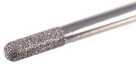
Pekkton® ivory Oberfläche mittels Diamant aufrauen. Tiefe Drehzahl und wenig Druck. Empfohlen wird eine Drehzahl zwischen 5'000 – 10'000 Umdrehungen pro Minute. Reinigung mit Alkohol.
