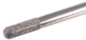
Oberfläche mittels Diamant aufrauen. Tiefe Drehzahl und wenig Druck. Empfohlen wird eine Drehzahl zwischen 5'000 – 10'000 Umdrehungen pro Minute.
