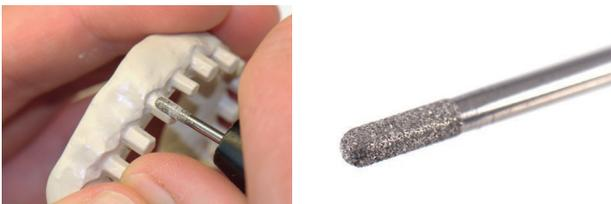
Oberfläche mittels Diamant aufrauen. Tiefe Drehzahl und wenig Druck. Empfohlen wird eine Drehzahl zwischen 5'000 – 10'000 Umdrehungen pro Minute.
