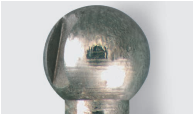
Efectos de una matriz de plástico: Daños irreparables del macho provocados por sustancias incluidas en el plástico.
