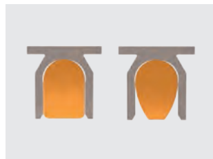
Fig. 1 Un logement dans les parties femelles fraisées protégé par un brevet améliore l'adaptation, prévient les effets ressort en cas d'activation importante et garantit un fonctionnement durable. Pour la gouttière articulée, un léger pincement est perceptible.
