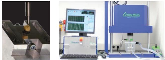
Abbildung 2: Prüfkörper im Probenhalter. Die Spitze der für die Belastung verwendeten Schubform befindet sich zentral auf der okklusalen Ebene (links). Messaufbau «Dyna-Mess TP 5 kN HF» für die Ermüdungsprüfung (rechts).
