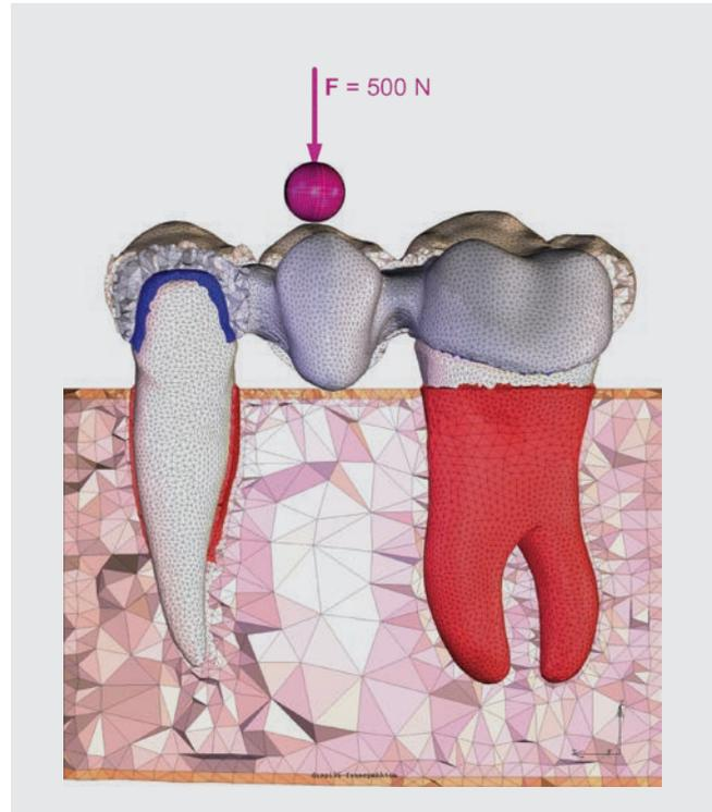
Abbildung 1: FE-Modell der dreiteiligen Brücke.
