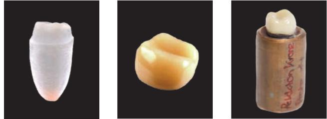
Abbildung 1: Stumpf aus PMMA (links), verblendete Molarenkrone mit Gerüst aus Pekkton® ivory (Mitte) und in kurzer Kupferröhre eingebetteter Prüfkörper auf der Höhe der Schmelz-Zement-Grenze (rechts).
