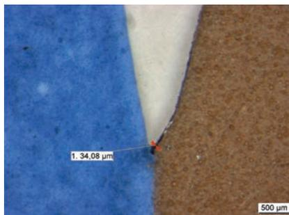
Distaler Abschnitt einer geprüften Krone. Der Randspalt ist 34,08 Mikrometer breit.
