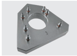
Demostración de la precisión de ajuste: Comprobado sobre modelos rígidos de acero con implantes
