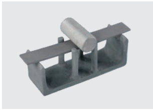
Medición de la deformación: Después de procesos de cocción simulados
