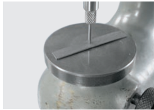
Medición de la deformación: Después de procesos de cocción simulados
