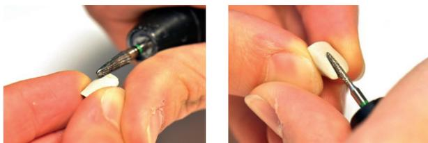
使用橫切銑刀將支架最終成型。加工使用的轉速為 5'000 – 10'000 rpm。加工過程中不要給對象施加過高的壓力。噴射前用金剛石銑刀打磨表面。用酒精清潔。
