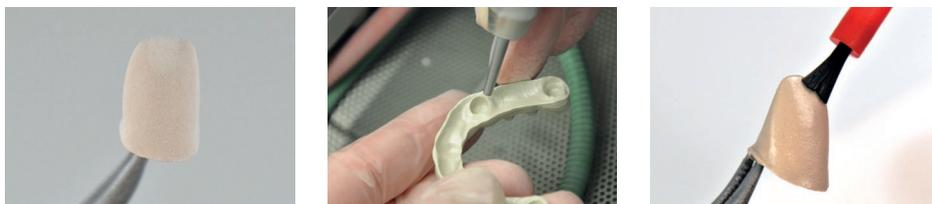
使用銑刀再加工後，用 110µm 的磨料以 2 bar 的壓力對支架進行噴砂處理。用酒精清潔。鑲嵌前，必須用以 MMA 為基礎的複合底漆塗覆 Pekkton® ivory 支架。
