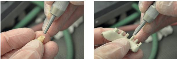
用粒度為 110µm 的非回收氧化鋁 ( $Al_2O_3$ ) 以 2-3 bar 的壓力對塑膠齒進行噴砂處理。用粒度為 110µm 的非回收氧化鋁 ( $Al_2O_3$ ) 以 2 bar 的壓力對 Pektkon® Ivory 進行噴砂處理。然後用無油的壓縮空氣或酒精清潔。切勿使用蒸汽清潔器！
