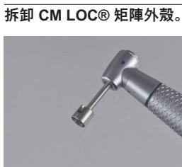
拆卸 CM LOC® 矩陣外殼時，請使用 CM LOC® 矩陣外殼抽提器。
