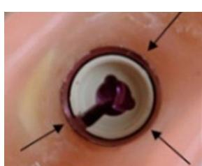
重合物がマトリクスハウジングに流れ込んでいないことを確認してください。必要に応じてプロセスインサートを取り除き、マトリクスハウジング内部の余分な重合物をブジーで取り除きます。
