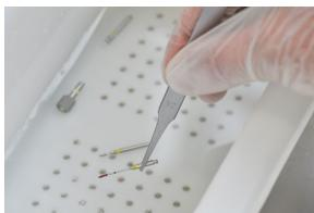
Занурити (розібрани) вироби на 5 хв (<40°C/104°F) в холодну воду. Обробити м'якою нейлоновою щіткою внутрішні та зовнішні поверхні, додаючи свіжу воду, та видалити всі забруднення (застосуйте при цьому лупу з 3-разовим збільшенням). Промивайте вироби холодною водопровідною водою, доки не залишиться будь-яких видимих забруднень. Уникайте висушування виробів до або під час очищення. Висушений біологічний матеріал дуже важко видаляти.
