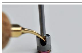
然後，使用儀器通過側面開口從 CM LOC® 矩陣外殼抽提器上卸下 CM LOC® 矩陣外殼。為了更好地取下，建議在火焰上短暫地加熱 CM LOC® 矩陣外殼抽提器。
