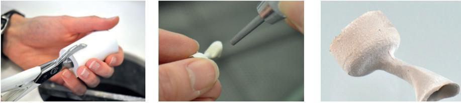
Das Grobausbetten erfolgt mit einer Ausbettzange und mit Vorsicht. Das Ausbetten erfolgt sobald die Muffel handwarm ist. Beim grossen Arbeiten nicht mit der Ausbettzange ausbetten. Die Feinausbettung erfolgt mit abrasivem, 110 µm Korundstrahlmittel und einem Druck von 2 bar. Einmal verpresstes Material darf nicht wiederverwendet werden.
