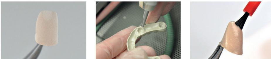
Nach der Überarbeitung mit den Fräsen wird das Gerüst mit abrasivem 110 µm Strahlmittel mit 2 bar Druck abgestrahlt. Reinigung mit Alkohol. Vor der Verblendung ist das Pekkton® ivory Gerüst zwingend mit Komposit-Primer auf MMA-Basis zu behandeln.
