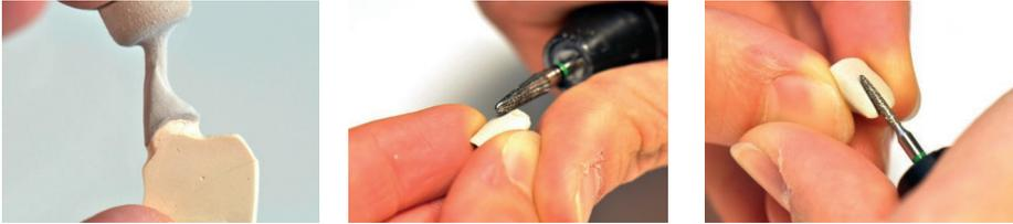
Mit kreuzverzahnten Fräsen wird das Gerüst in die finale Form gebracht. Die Ausarbeitung erfolgt mit 5'000 – 10'000 U/min. Nicht mit zu hohem Druck auf dem Objekt arbeiten. Vor dem Strahlen wird die Oberfläche mittels einer Diamantfräse aufgeraut. Reinigung mit Alkohol.
