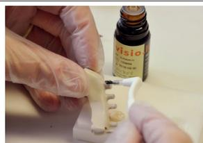
Ätzgel unter fließendem Wasser abspülen. Komposit-Primer auf die Oberfläche des Pekkton® ivory Gerüsten auftragen und gemäss Gebrauchsanweisung des Herstellers lichten.
