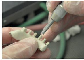
Abstrahlen der Kunststoffzähne mit nicht rezyklierten Aluminiumoxid ( $\text{Al}_2\text{O}_3$ ) mit einer Körnung von  $110\mu\text{m}$  und einem Druck von 2 – 3 bar. Pekkton® ivory Gerüsten mit nicht rezyklierten Aluminiumoxid ( $\text{Al}_2\text{O}_3$ ) mit einer Körnung von  $110\mu\text{m}$  und einem Druck von 2 bar abstrahlen. Anschließend mit ölfreier Druckluft oder mit Alkohol reinigen. Nicht mit dem Dampfreiniger!
