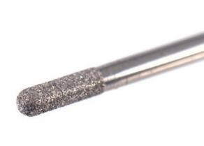
Pekkton® ivory Oberfläche mittels Diamant aufrauen. Tiefe Drehzahl und wenig Druck. Empfohlen wird eine Drehzahl zwischen 5'000 – 10'000 Umdrehungen pro Minute. Reinigung mit Alkohol.
