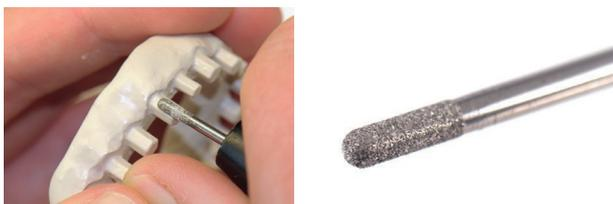
Oberfläche mittels Diamant aufräuen. Tiefe Drehzahl und wenig Druck. Empfohlen wird eine Drehzahl zwischen 5'000 – 10'000 Umdrehungen pro Minute.
