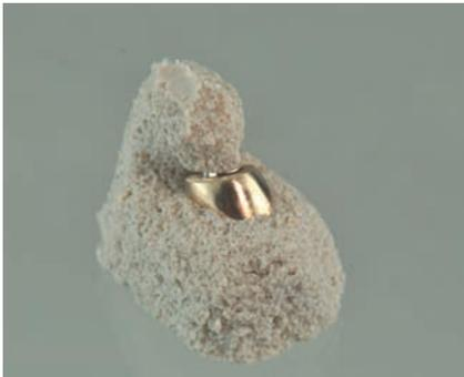
L'interstice de brasage doit être régulier et sa largeur comprise entre 0,05 et 0,20 mm. Puis former le bloc de soudage de telle manière que la partie mâle soit fermement maintenue et garantisse un bon accès aux flammes (veiller à avoir un solidus correspondant).
