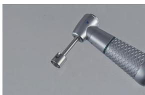
Pour démonter le boîtier de parties femelles CM LOC®, utiliser l'extracteur pour boîtier de parties femelles CM LOC®.
