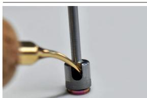
Extraire ensuite le boîtier de parties femelles CM LOC® de l'extracteur pour boîtier de parties femelles CM LOC® en insérant un instrument dans l'ouverture latérale. Pour faciliter l'extraction, il est recommandé de chauffer brièvement le boîtier de parties femelles CM LOC® au-dessus d'une flamme.
