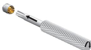
ラメラリテンションインサートの活性化、不活性化および取外には、スクリュードライバー/活性化剤（商品番号072609）が必要です。4つのカム付きインスツルメントは、正しく取り付けられていれば、ラメラリテンションインサート内でストッパーまで移動します。維持力の設定は、回すことによって行われます。時計回りに回せば維持力が増大し、逆に回せば維持力が低下します。
