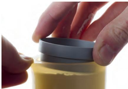
Nachdem das Objekt gedeckt ist, den Rüttler abstellen und die Muffel bis zur Markierung mit der restlichen Einbettmasse auffüllen. Silikonmuffelrand leicht herausdrücken, den Muffeldeckel platzieren und einmal im Uhrzeigersinn um 180° drehen (Elimination von Blasen).
