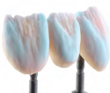
Mit einer weiteren, minimalen Enamelschichtung die Form anatomisch reduziert auftragen und mit einem «Big-Brush» oberflächlich gut verdichten. Bei Brückenverbindungen interdental bis auf das Gerüst separieren. Die Arbeit ist nun bereit für den ersten Dentinbrand, der um 2 °C tiefer als der Gerüstcharakterisierungsbrand bei 778 °C erfolgt.
